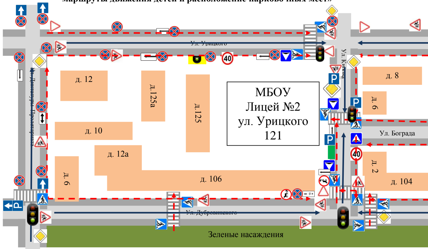
Схема 2. «Организации дорожного движения в непосредственной близости от МБОУ Лицей № 2 с размещением соответствующих технических средств, маршруты движения детей и расположение парковочных мест»
